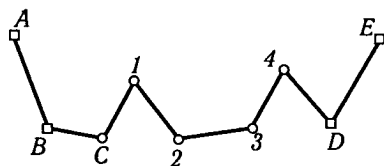
Рис. 67. Схема прив'язки теодолітного полігона до пунктів геодезичної мережі
