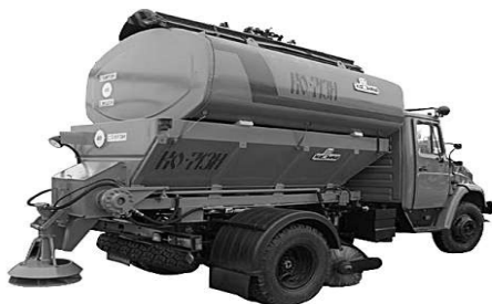
Рис. 13.7. Комбінована машина КО-713Н для утримання дорожніх покриттів, майданів, проїздів, тротуарів, доріг шириною 3 м
