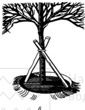
Рис. 11.14. Способи зміцнення растяжками дерев після посадки:
