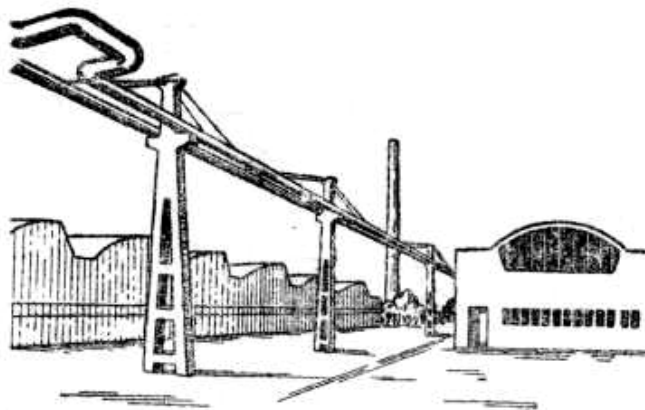
Мал.4.34. Надземне прокладання теплових мереж на опорах
