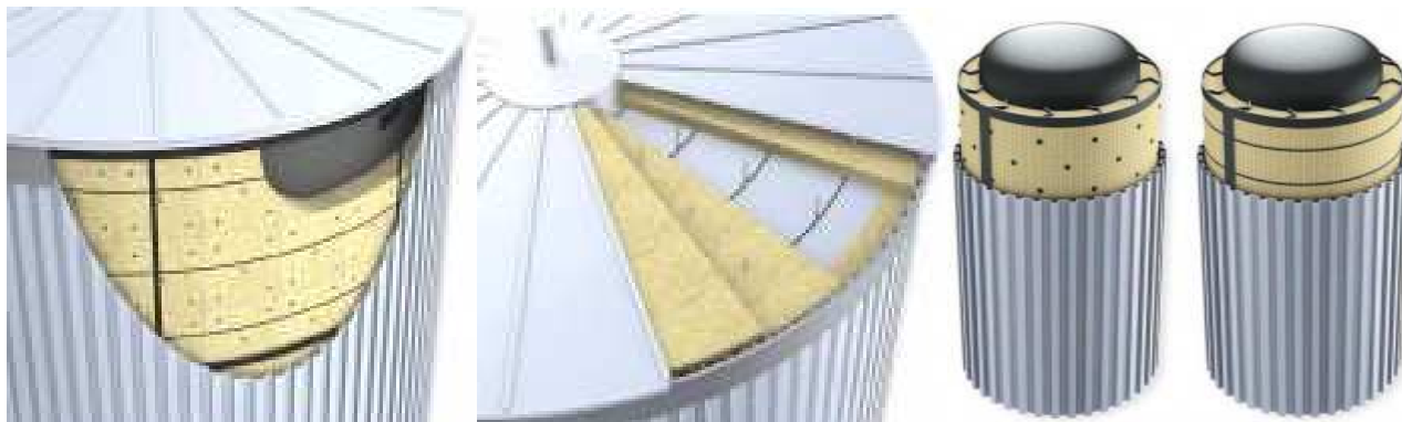
Рисунок 10.14 – Схеми ізолювання сталевих резервуарів панельними повнозбірними конструкціями
