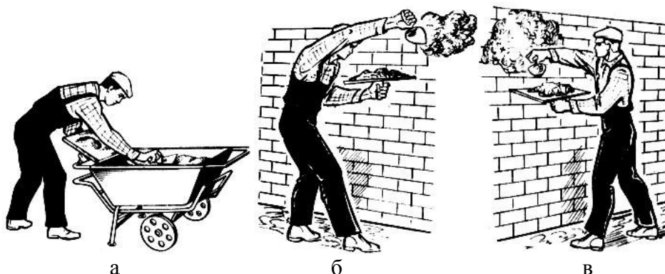
Рисунок 12.6 – Накидання розчину кельмою на стіни: а – накладання розчину на сокіл; б – накидання розчину на рівні голови зліва направо; в – те саме, справа наліво
