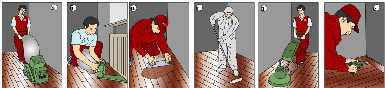
Рисунок 14.21 – Послідовність оздоблювання паркетної підлоги: а, б – шліфування; в – шпаклювання та ґрунтування; г – покриття лаком; д – натирання; е – установа плінтуса
