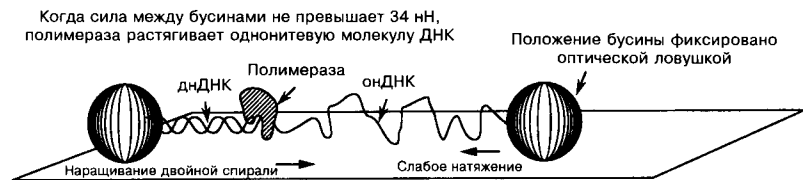
Рис. 8.6. Оптическая ловушка для измерения влияния натяжения ДНК-матрицы на активность ДНК-полимеразы фага T7 (рис. 8.7; Smith et al., 1996; Wuite et al., 2000).
