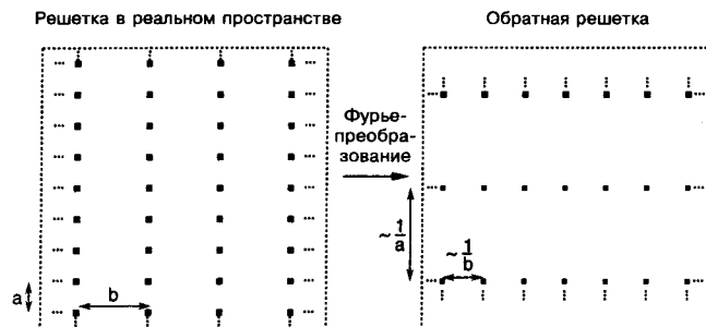
Рис. 4.10. Фурье-преобразование кристаллической решетки становится так называемой обратной решеткой. Оно определяет максимальное число и положение наблюдаемых дифракционных пятен.
