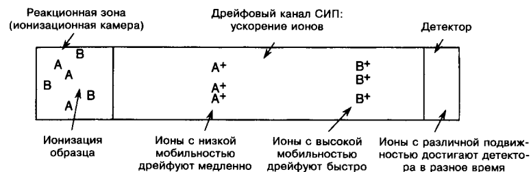
Рис. 10.1. Принцип действия спектрометров ионной подвижности. Генерируемые молекулярные ионы накапливаются в реакционной зоне. Селекторный (стрибирующий) импульс переносит молекулярные ионы в дрейфовый канал, где они ускоряются с помощью электрического поля. В газовой среде дрейфового канала ионы с различной подвижностью достигают детектора за разное время.
