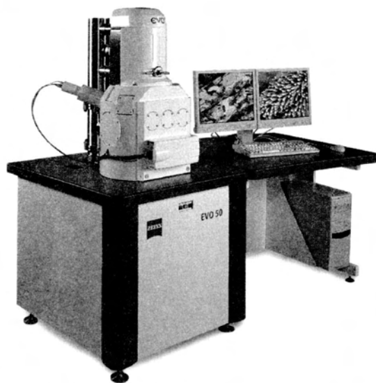
Рис. Д20. ZEISS EVO 50 EP — растровый микроскоп № 1 для решения задач в биологии и медицине (увеличение от 5\times до 10^6\times ).
