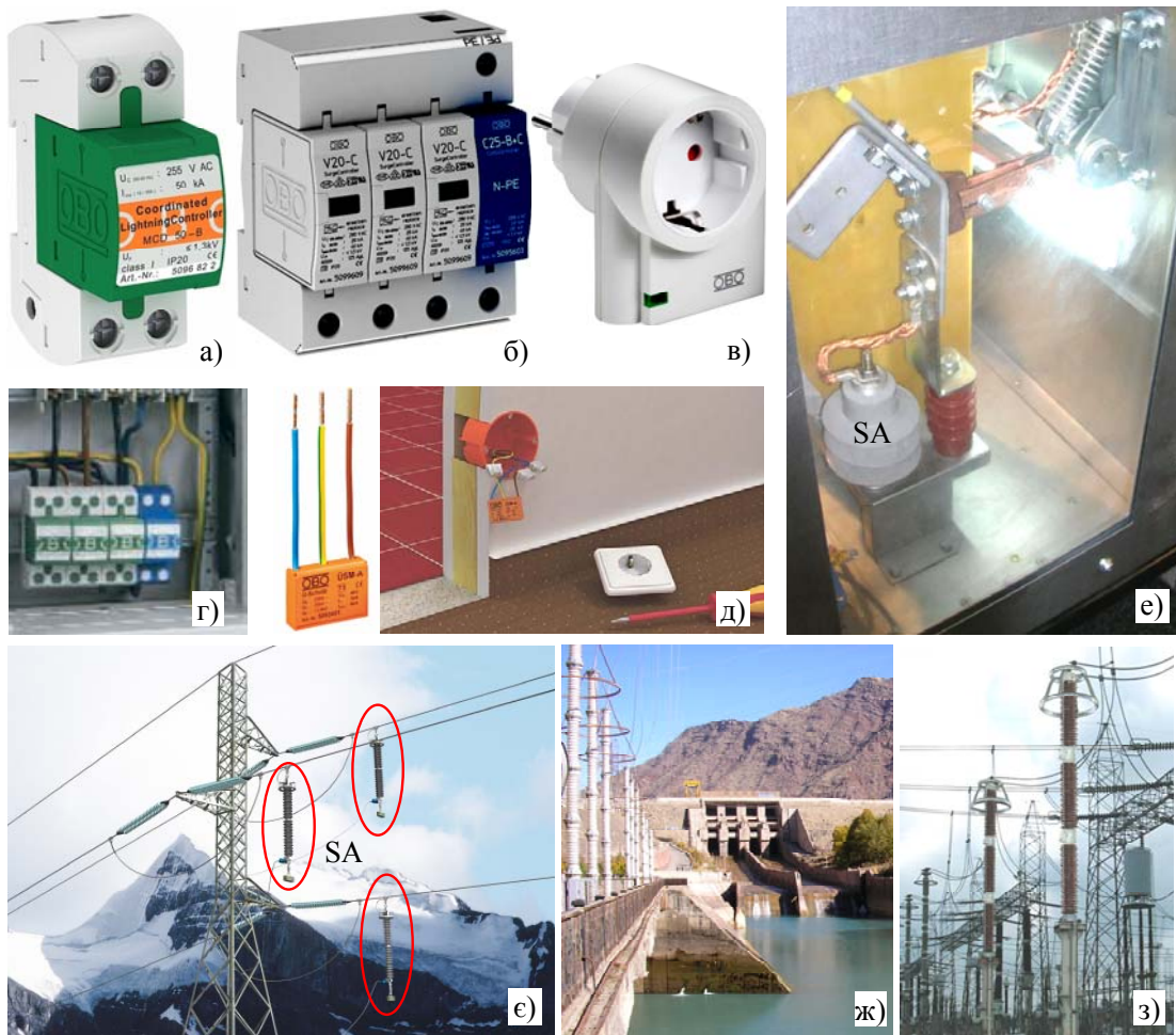
Рис. 4.131. Обмежувачі імпульсних виплесків та деякі приклади їх застосування: а – обмежувач імпульсних виплесків струму (SPD типу I або B) для мереж низької напруги; б – обмежувач імпульсних виплесків напруги (SPD типу II або C) для мереж низької напруги; в – мобільний обмежувач для захисту електронних пристроїв; г – обмежувачі імпульсних виплесків в розподільному щитку низької напруги; д – обмежувач імпульсних виплесків напруги (SPD типу III або D) та його монтування в розетці електропроводки; е – обмежувач імпульсних виплесків в комірці розподільного пристрою середньої напруги; є – обмежувачі імпульсних виплесків струму (блискавкозахист) на високовольтній лінії електропередачі; ж – обмежувачі імпульсних виплесків на гідроелектростанції; з – обмежувачі імпульсних виплесків в складі високовольтної підстанції
