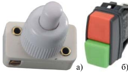
Рис. 4.73. Кнопкові перемикачі з подвійним натисканням на кнопку, щоб змінити стан контактів та повернути їх у початковий стан (push-push switch): а – однополюсний вимикач; б – двополюсний вимикач залежної дії
