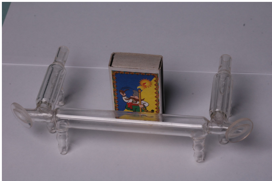
Рис. 26.7. Газоразрядная трубка волноводного лазера высокого давления (фото автора)
