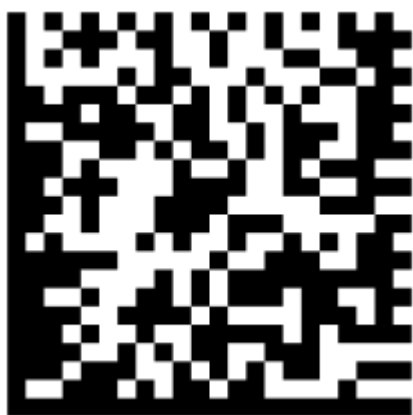
Рис. 2.3. Приклади коду Data Matrix, що кодує текст: а - «Wikipedia, the free encyclopedia»; б - двовимірний штрих-код на медичному рецепті
