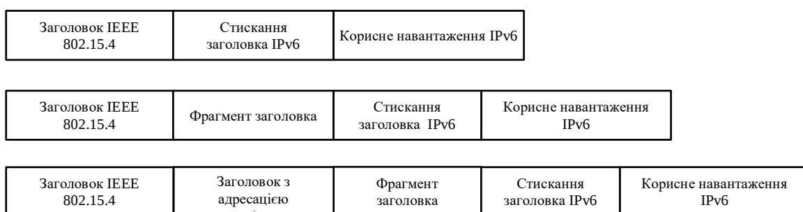
Рис. 3.12. Розташовані у вигляді стека заголовки 6LoWPAN
