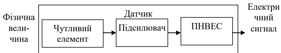
Рис. 2.10. Будова найпростішого датчика
