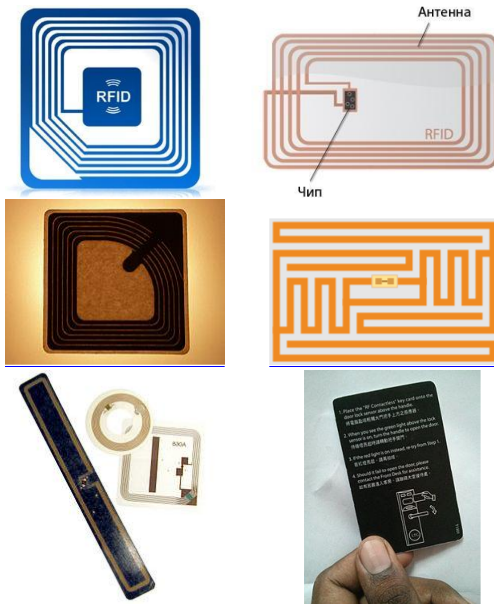
Рис. 2.9. Приклади антен RFID-міток
