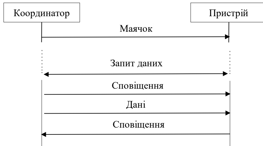
Рис. 3.2. Процес передачі даних від координатора до пристрою
