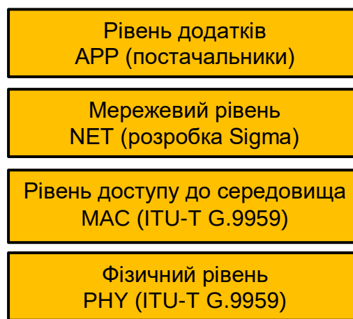
Рис. 3.8. Стек протоколу Z-Wave
