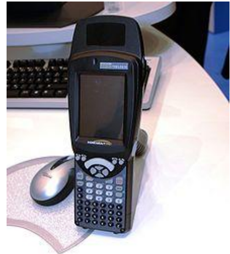
Рис. 2.5. Приклад універсального промислового зчитувача кодів
