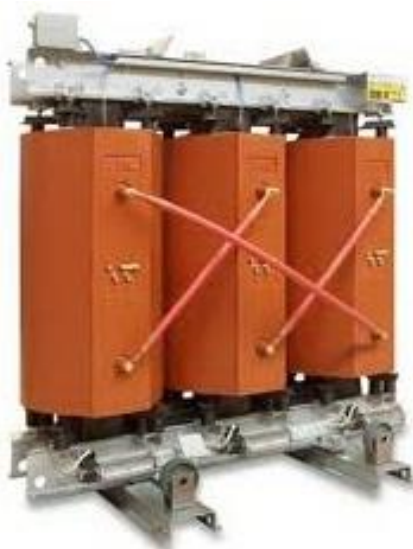
Рис. 3.44 – Активна частина (без захисного кожуха) трансформатора з ізоляцією класу 155 °С з алюмінієвими обмотками потужністю 160 кВА, напругою 15 кВ (тип ТСА-160/15)
