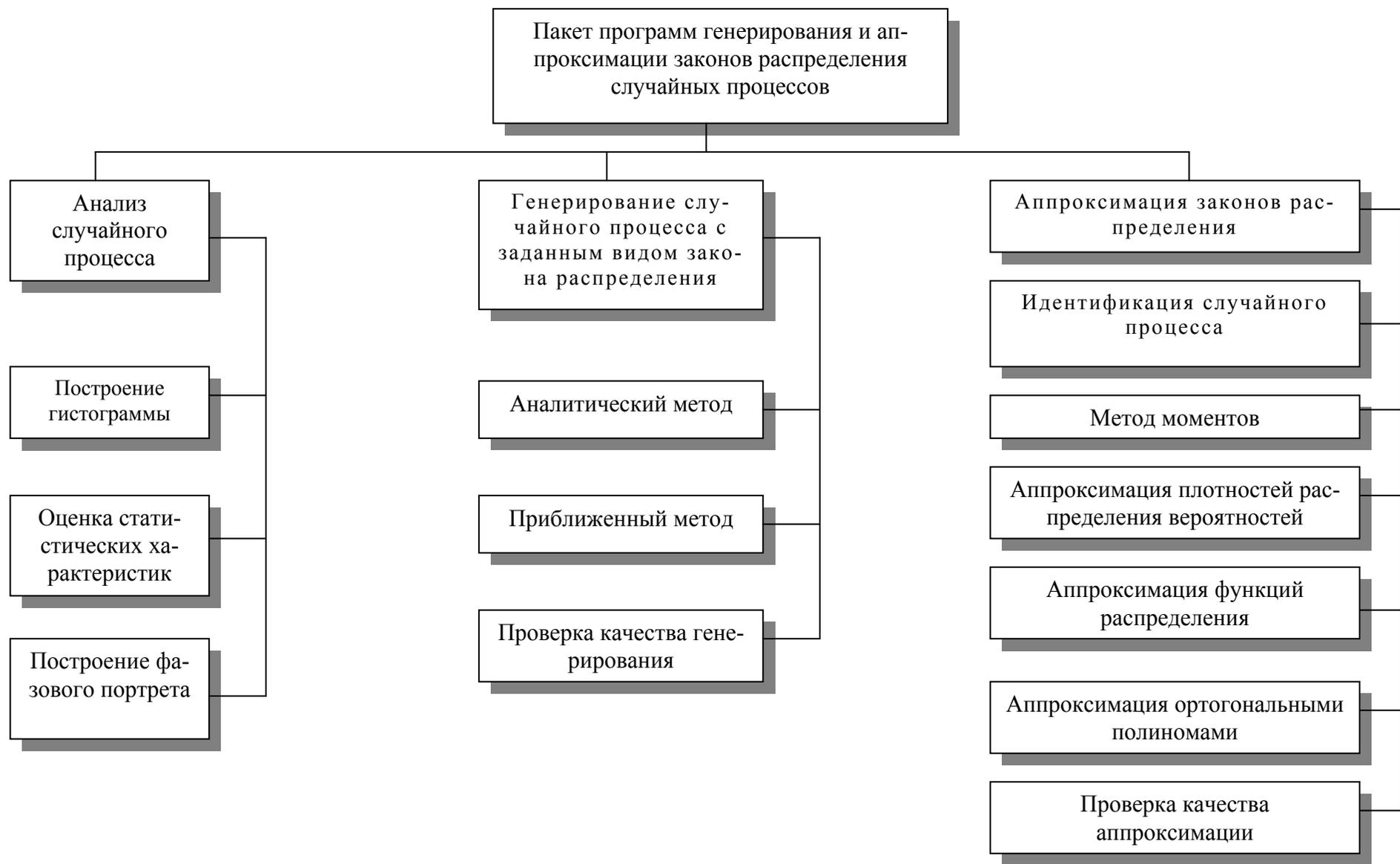
Рисунок 8.1. Пакет программ генерирования и аппроксимации законов распределения случайных процессов
