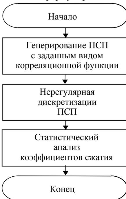
Рисунок 9.2. Блок-схема анализа коэффициентов сжатия данных
