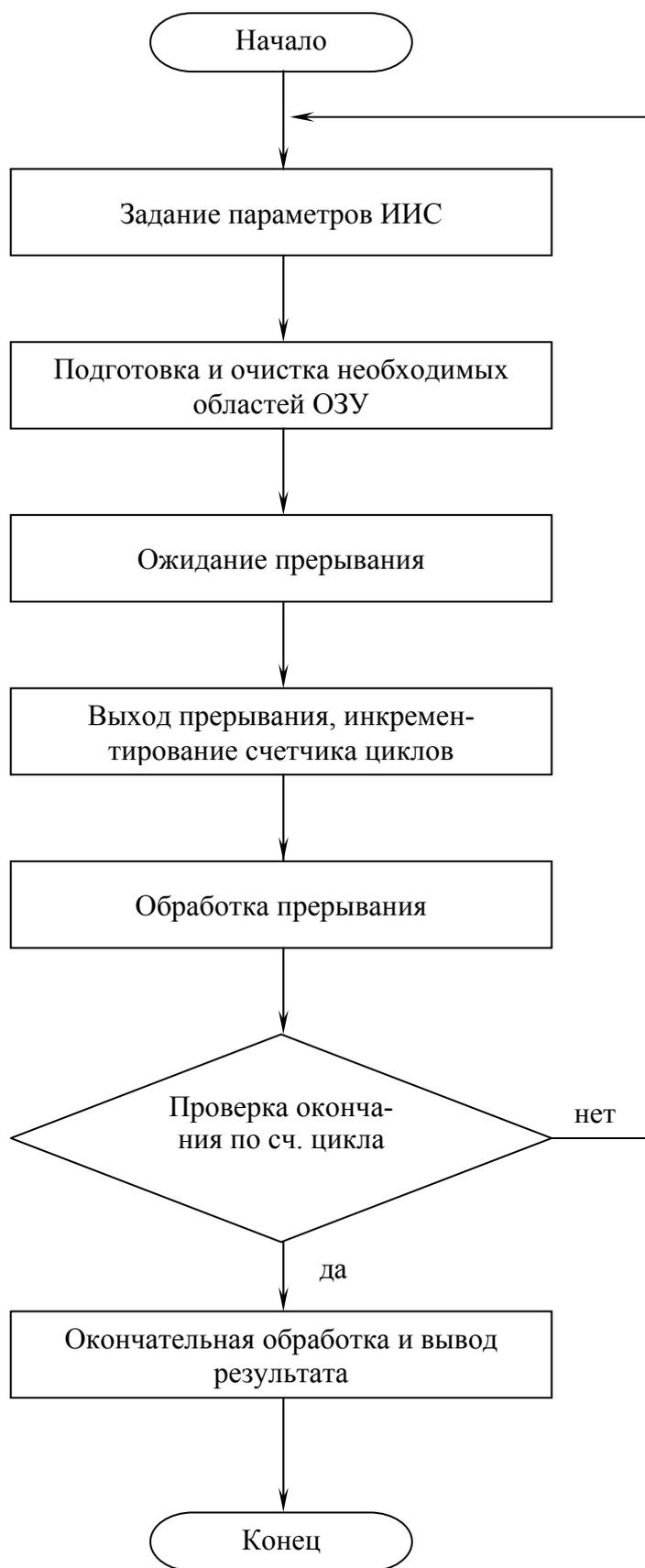
Рисунок 5.7. Блок-схема программы измерения
