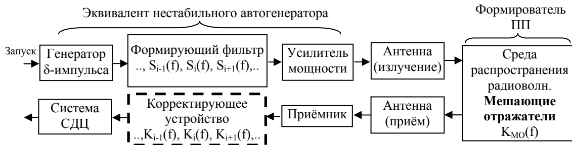
Рис. 1. Эквивалентная схема радиолокационного тракта
