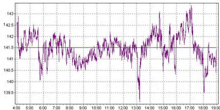
Рис. 6. Результаты определений координат потребителя по высоте при применении технологии точного позиционирования
