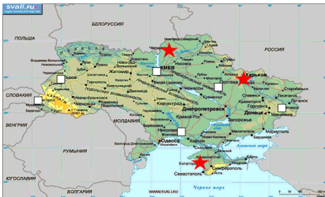
Рис. 1. Карта размещения по территории Украины действующих референционных станций кодовой ПШДК СКНОУ (обозначены звездочками) и перманентных станций, /использованных для оценки точности (обозначены белыми квадратами)
