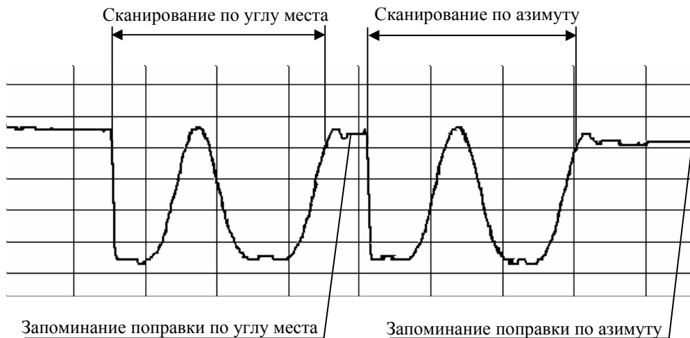
Рис. 3. Сигнал калибровочного радиоисточника при сканировании
