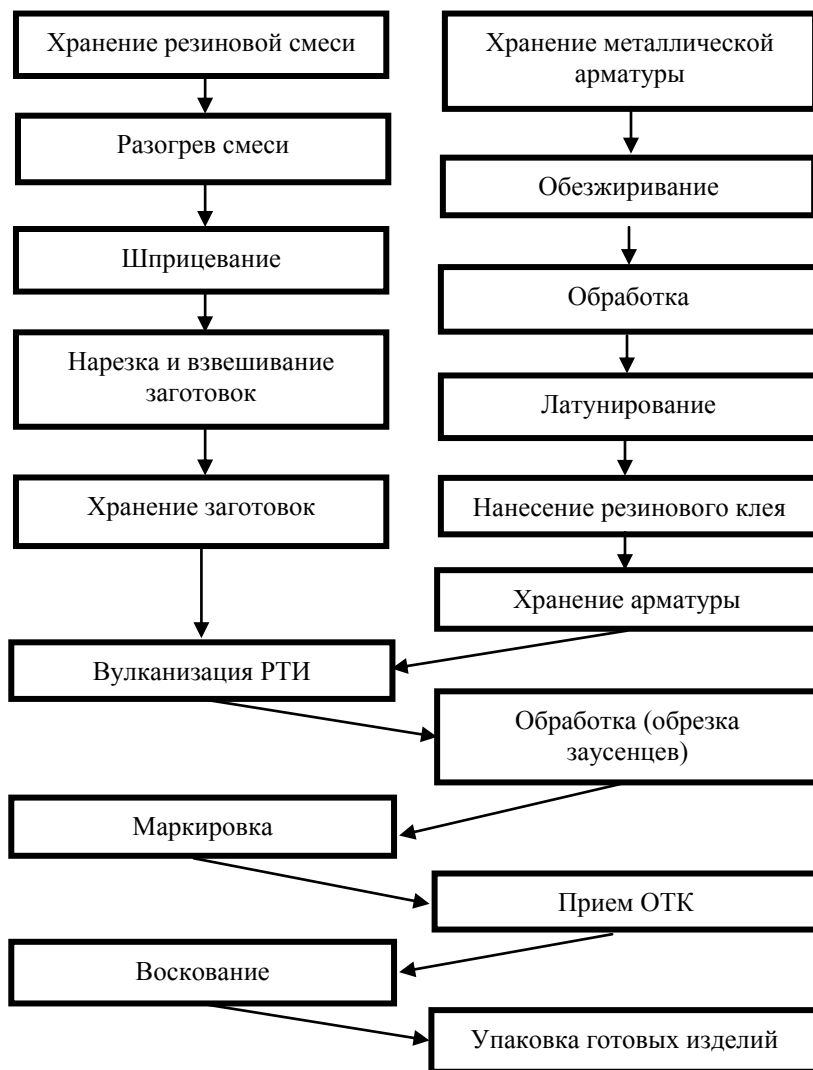
Рис. 1.24. Технологическая схема производства резинометаллических элементов
