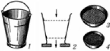
Рис. 63. Пристрій для відмивання коренів з невеликих зразків ґрунту: 1 — відро; 2 — положення сит у відрі; 3 — верхнє сито; 4 — нижнє сито
