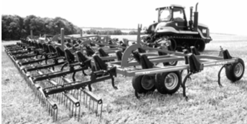
Рис. 67. Начіпний культиватор FG HORSCH для незаглибленого обробітку ґрунту:
